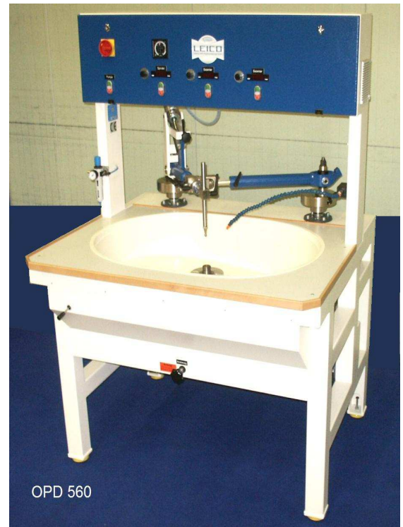
OPD 560 mit 2 anetr. Exzentern und Pneumatikdruck
