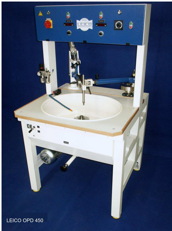
LEICO OPD 450 OPD 450 mit 1 anetr. Exzenter und Pneumatikdruck
